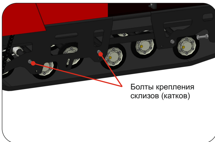
Рис. 13. Регулировка угла «атаки» МБС 3.
