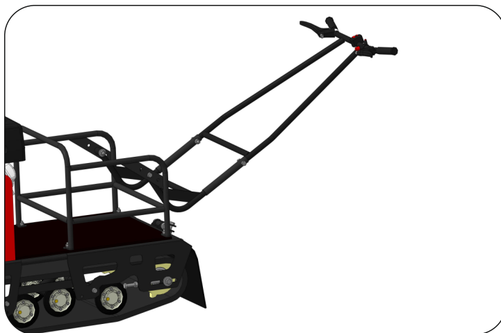
Рис. 16. Регулировка руля МБС 1, МБС 2, МБС 3.
